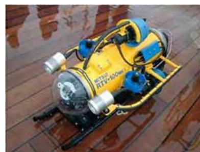
水中テレビカメラ装置 Underwater TV vehicle
