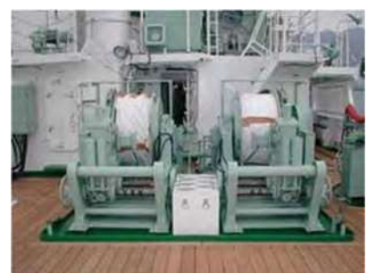
曳網ウインチ / Trawl winch
