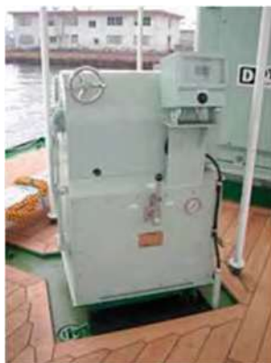
観測ウインチ / Oceanographic survey winch
