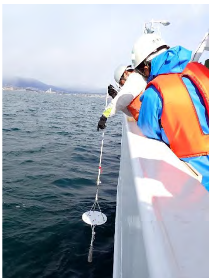
透明度板を使った海の濁り具合の調査
