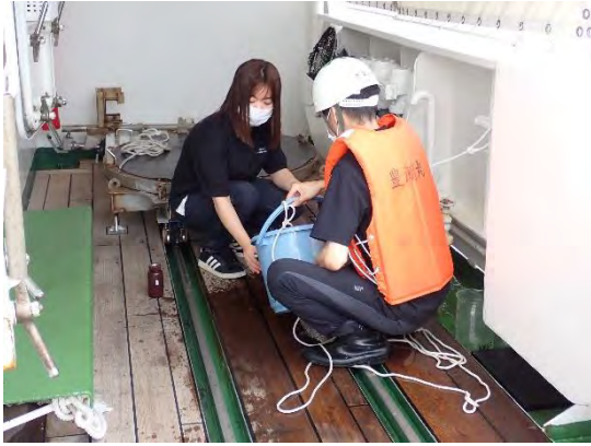
ニスキン採水器を降ろしている間に表層水を ボトルに詰める
