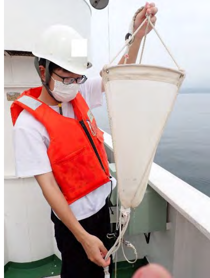
プランクトンネットによる植物プランクトンの採集
